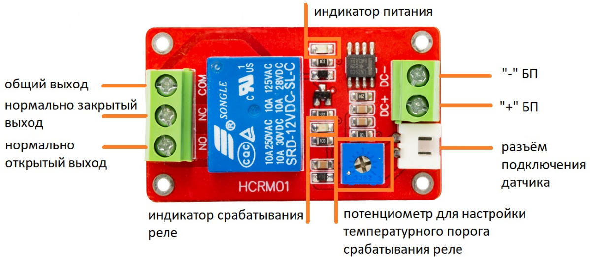
Рис. 1. Описание функциональных узлов модуля HCRM01
