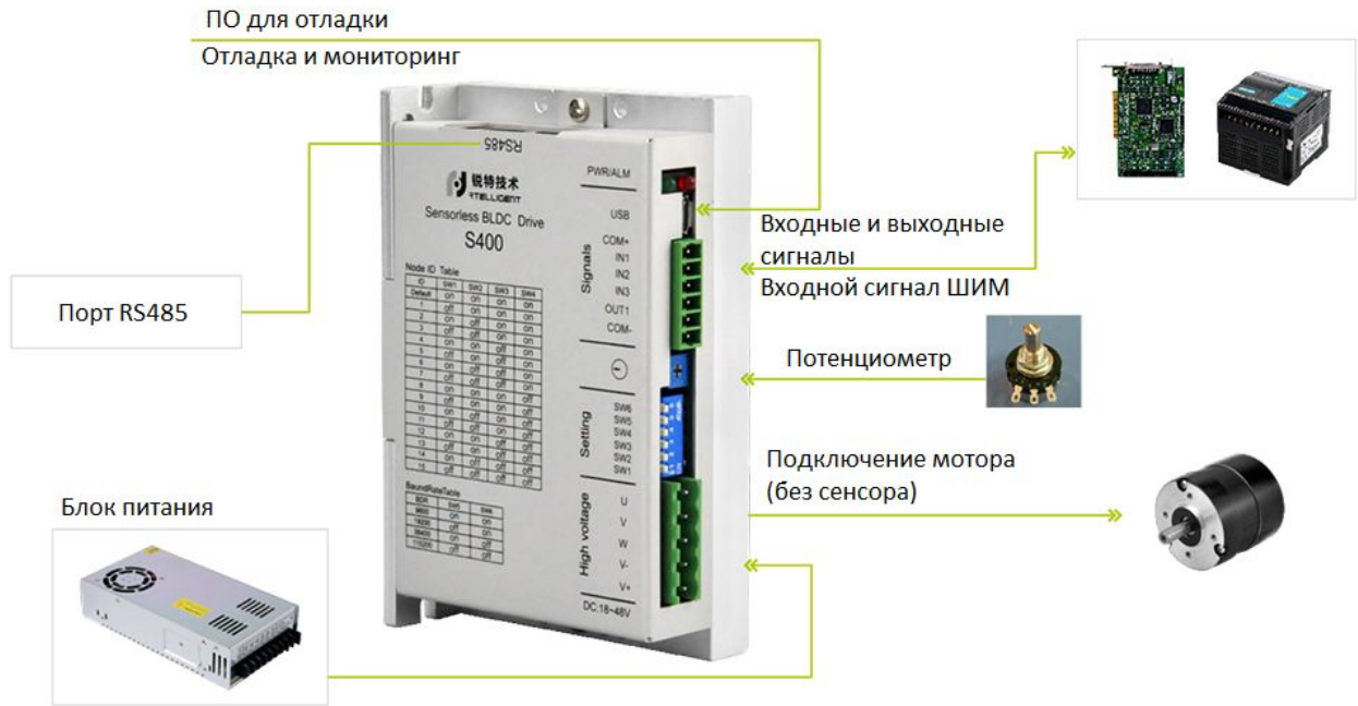
Рис. 2. Блок-схема подключения драйвера S400
