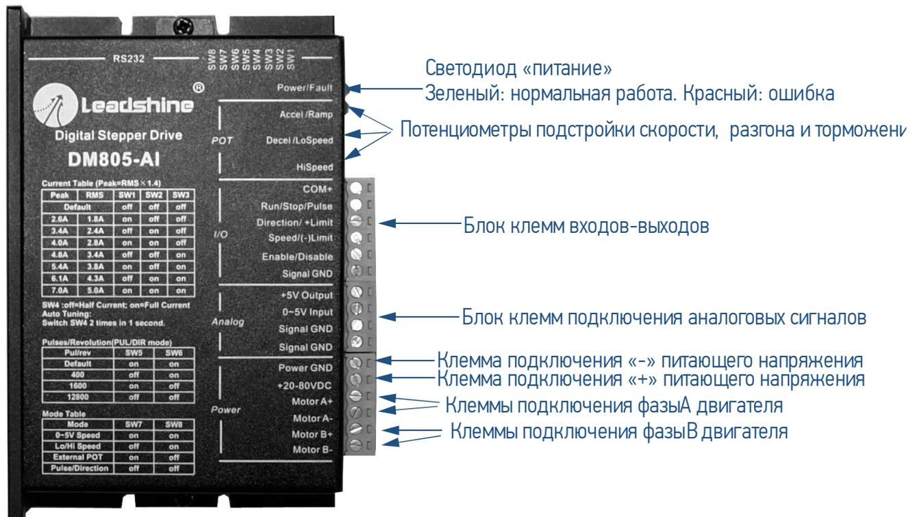
Контакты драйвера сгруппированы в три блока клемм, а также на корпусе располагается группа из 3 потенциометров. Назначение элементов отличается в зависимости от выбранного режима работы. Выбор режима работы осуществляется переключателями SW7 и SW8 согласно таблице:
