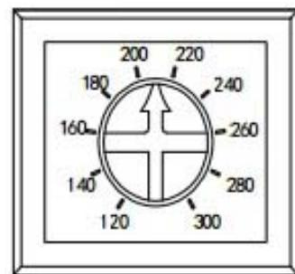
Примечание: Для защиты двигателя, установите номер стрелки, так же, как и двигатель номинированной мощности. При возникновении перегрузки в драйвере сработает режим защиты.
