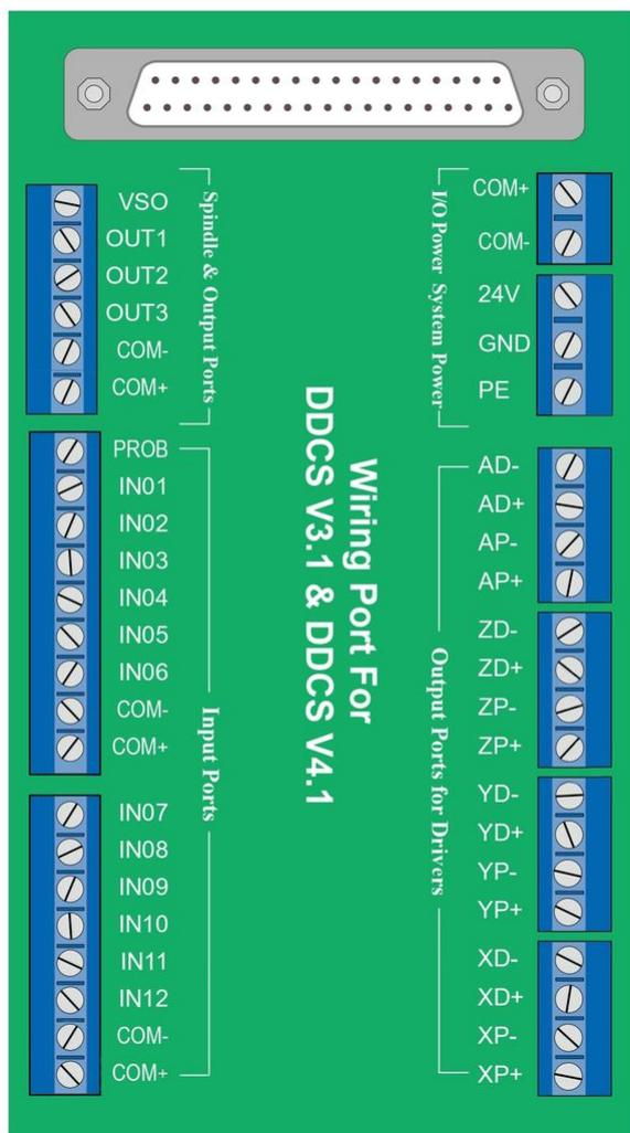
Рис. 7. Клеммная плата для DDCS V4.1
