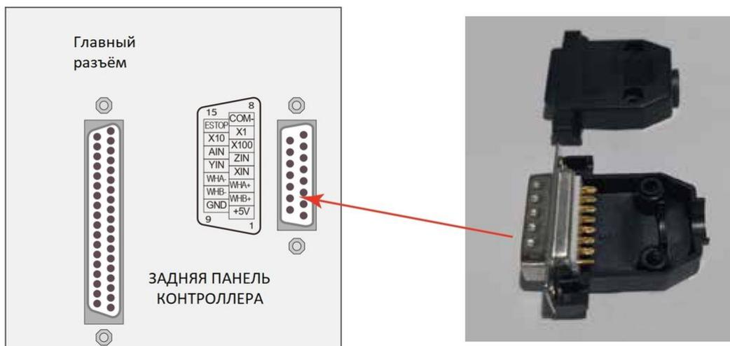
Рис. 18. Разъём MPG
