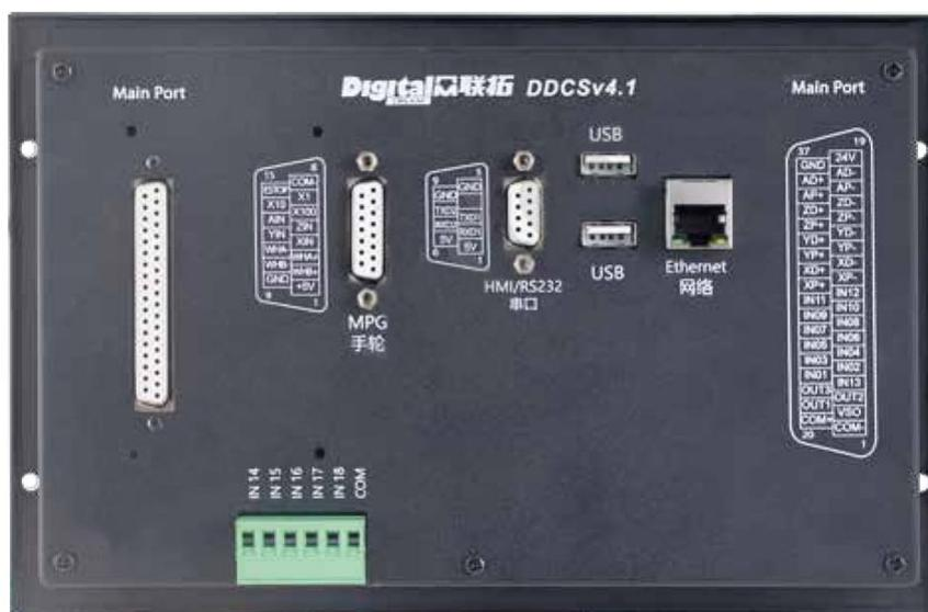
Рис. 2. Задняя панель DDCS V4.1
