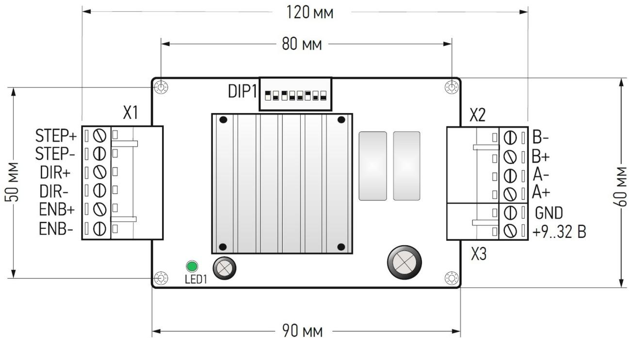
Рис. 1. Габаритные размеры и распиновка драйвера STB42-1
