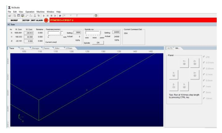
Если процедура определения домашнего положения портала станка по соответствующим осям не была произведена, то при срабатывании концевого датчика движение портала блокируется в обоих направлениях. Снять ограничение возможно с помощью меню "Disable Mechanical Limits" (Operation>> Disable Mechanical Limits). Ознакомьтесь с разделом "Ручное перемещение портала станка".
