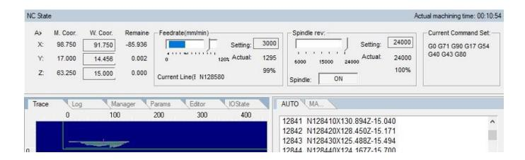
Выполнение УП можно приостановить (соответствующие кнопки на панели инструментов). С помощью кнопки "Восстановление" возможно запустить последнюю остановленную УП с точки останова. Для удобства отображения в строке меню View включаются функции отображения номеров строк команд и слежения за текущей выполняемой командой УП (View>> Show File Line number и View>> Trace Current Line).
