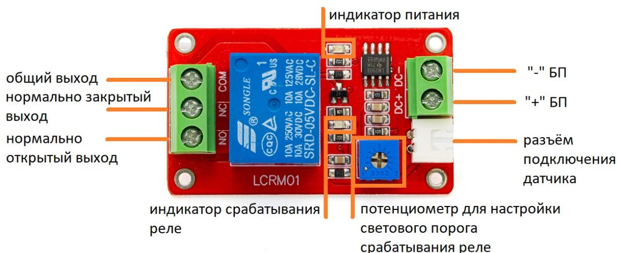
Рис. 1. Описание функциональных узлов модуля LCRM01
