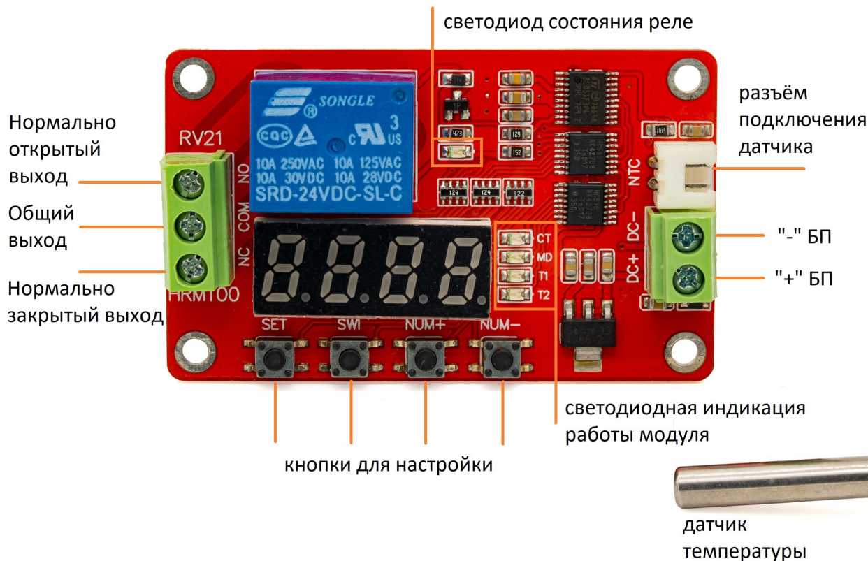
Рис. 1. Описание функциональных узлов модуля HRM100
