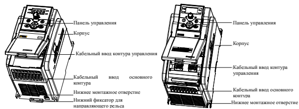
Рисунок 1-2. Внешний вид и названия деталей преобразователей категории II Модели: E550-2S0015(B)~E550-2S0022(B)/ E550-4T0007(B)~E550-4T0022(B)
