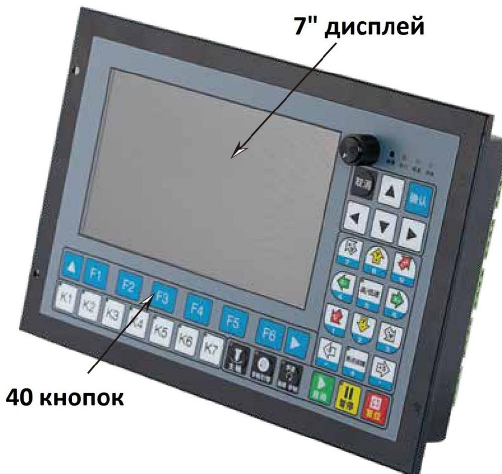
Рис. 1. Передняя панель DDCS Expert
