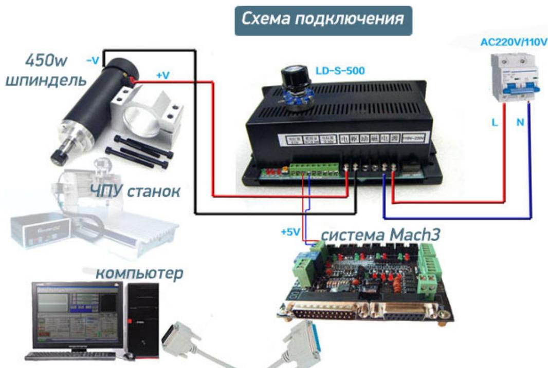
Рис. 2. Схема подключения блока управления LD-S-500
