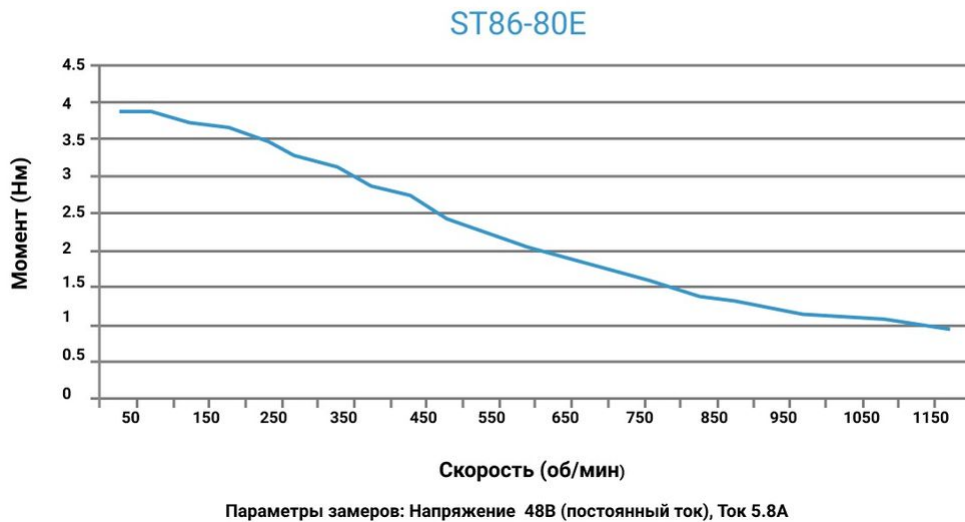
Рис. 12. График зависимости момента от скорости для двигателя ST 86-80E
