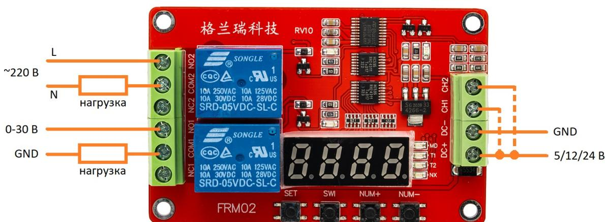
Рис. 2. Пример подключения нагрузки
