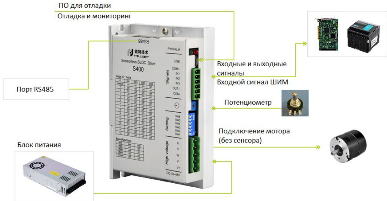
Рис. 2. Блок-схема подключения драйвера S400
